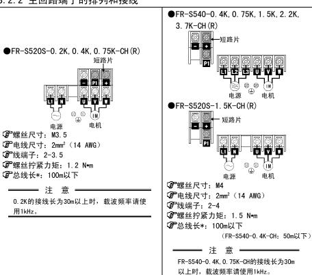
\*用Pr. 98"自动转矩提升选择(电机容量)"选择自动转矩提升时: 30m以下
